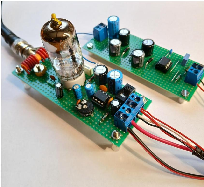
Comme on peut voir sur la photo, le montage a été réalisé sur une plaque d'expérimentation Eurocard à trous séparés, ce qui n'est sans doute pas idéal et tout cas pas souvent recommandé pour les montages VHF. La photo montre le récepteur avec le tube ECC81 et le LM386 en avant plan et le quadrupleur de tension basé sur un timer 555 en second plan. On voit distinctement le condensateur ajustable, le petit transformateur d'entrée antenne à 3 spires au primaire et 6 spires au secondaire.
