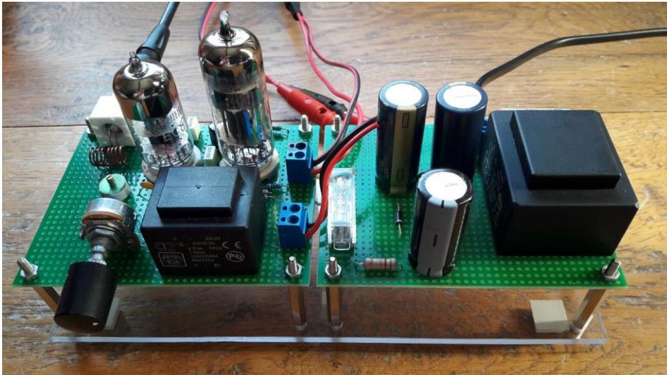
La deuxième photo montre le même récepteur avec cette fois, l'alimentation de 163 Volts construite à partir de deux transformateurs 230 / 2 X 24 Volts RMS. On voit les deux condensateurs de filtrage en parallèle, la résistance de bleeder et le fusible de sécurié de 80 mA.
