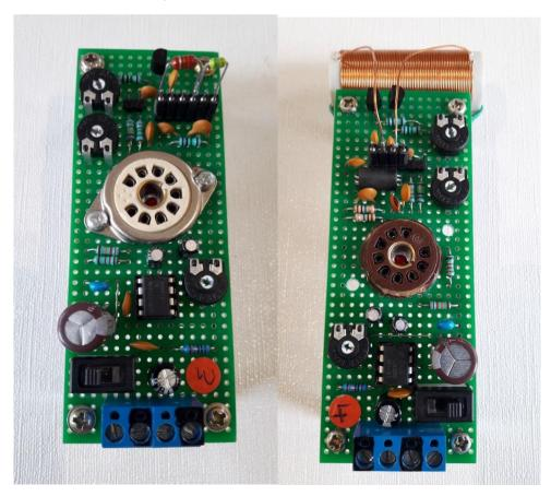
Ces deux dernières photos montrent les 4 récepteurs Ondes Courtes qui ont été construits sur le même type de support « carte à trous isolés » et qui présentent pas mal de ressemblances dans leur construction. A gauche, les récepteurs avec des inductances moulées qui ne prennent pas beaucoup de place. Et à droite, les mêmes récepteurs avec des selfs faites maison (plus spectaculaire), qui fonctionnent tout aussi bien.
