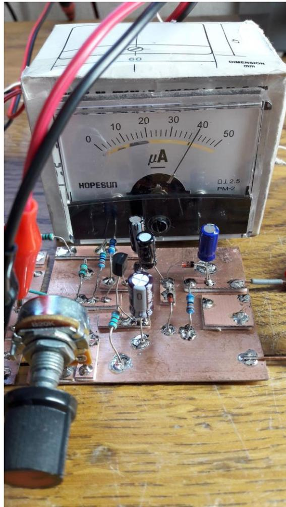
La photo montre le vu-mètre dans sa version montage Manhattan. On voit le potentiomètre de contrôle du niveau d'entrée et le galvanomètre 50  $\mu$ Ampère. Ce montage fait appel à un transistor 2N3904 et à deux diodes de redressement 1N4148 comme indiqué sur le schéma de réalisation.
