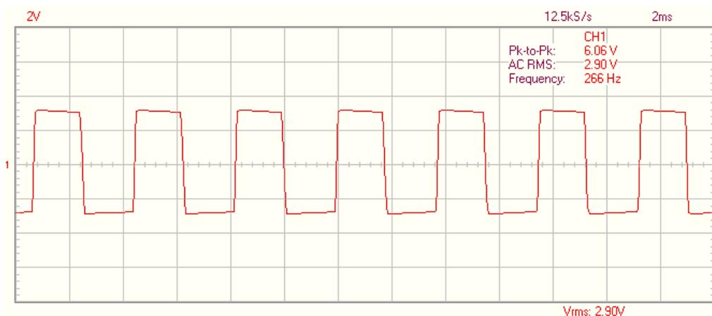
**Figure 03. Analyse spectrale pour VCC +9-V/-9 V, Rg = 57 K Ra =5120 Ohms**
